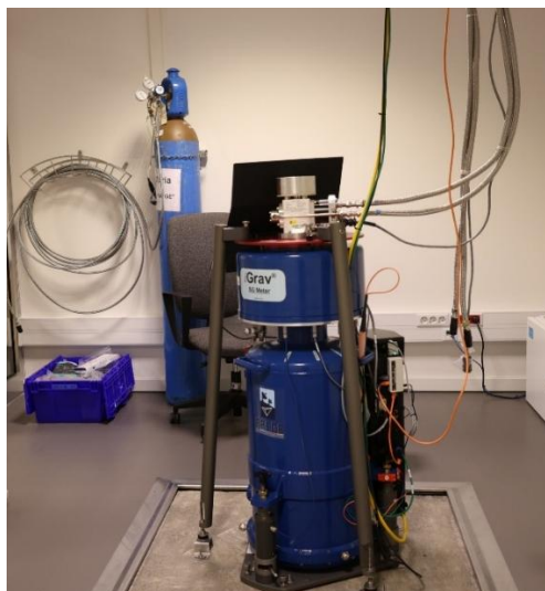
Figura 15 – Gravímetro supercondutor e a garrafa de hélio ao fundo, necessária ao seu funcionamento.
