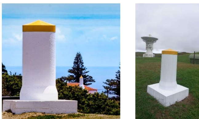
Figura 11 – Pilares do Local Tie
