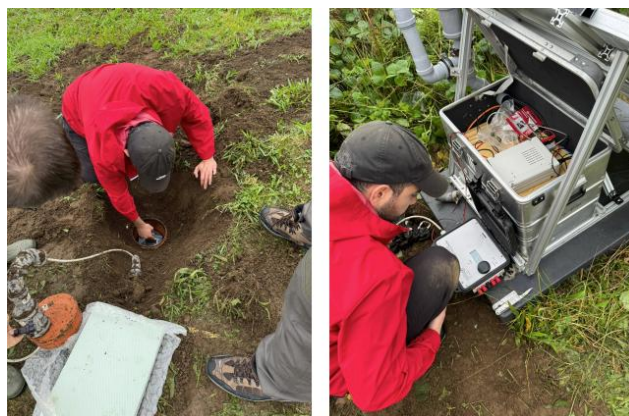
Figura 19 – À esquerda: orientação do sensor magnético. À direita: verificação das leituras magnéticas.
