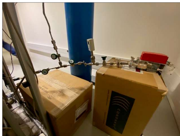
Figura 12 - Montagem necessária para a recarga de hidrogénio
