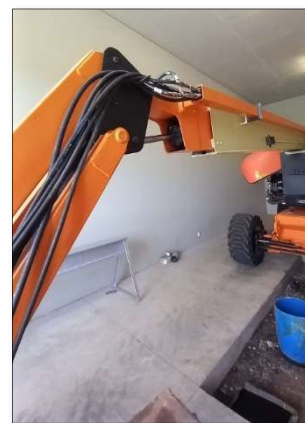
Figura 02 - Montagem tubos hidráulicos na Cherry Picker
