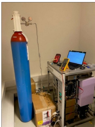
Figura 12 - Montagem necessária para a recarga de hidrogénio
