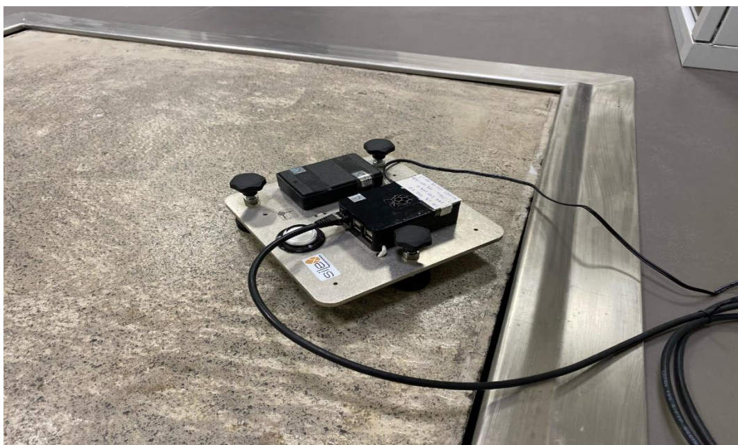
Figura 7 – Nova versão do acelerómetro SILEX instalado na sala do sismógrafo
