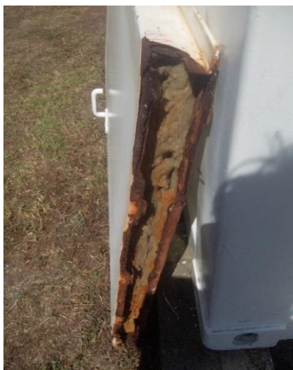
Figura 12 – Danos devido à corrosão
