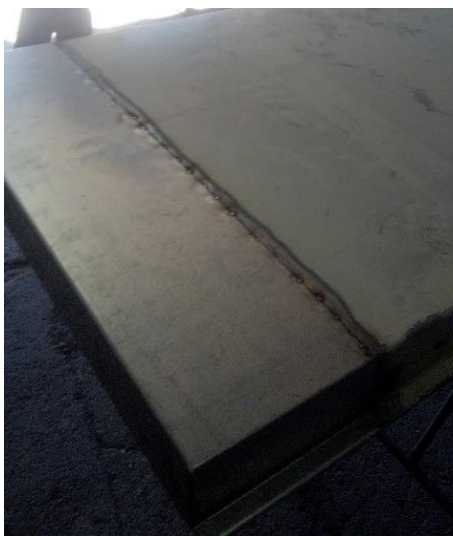
Figura 13 – Pormenor de soldadura MIG
