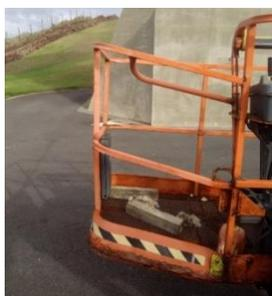
plataforma elevatória JLG com os contra-pesos do radiotelescópio, durante uma tarefa de manutenção, o cesto ficou parcialmente danificado.
